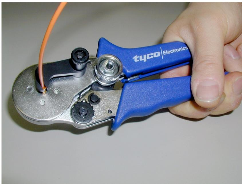
压紧前检查夹钳是否在位置“C”（压紧力度）！
