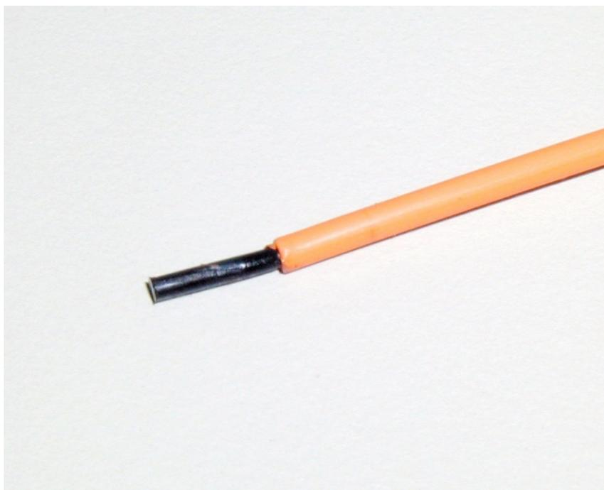
用第一个夹钳加工结果：干净定长的、带光滑切割面的光纤电缆。
