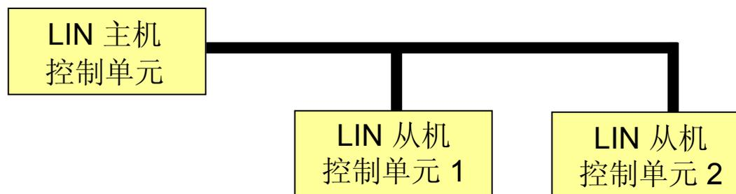
无论短路出现在何处，无论是发生在 LIN 线路上、在 3 个控制单元其中一个或是在两个控制单元中，也无论是否接地或者连接蓄电池电源，系统都将关闭且无法联络从机。
