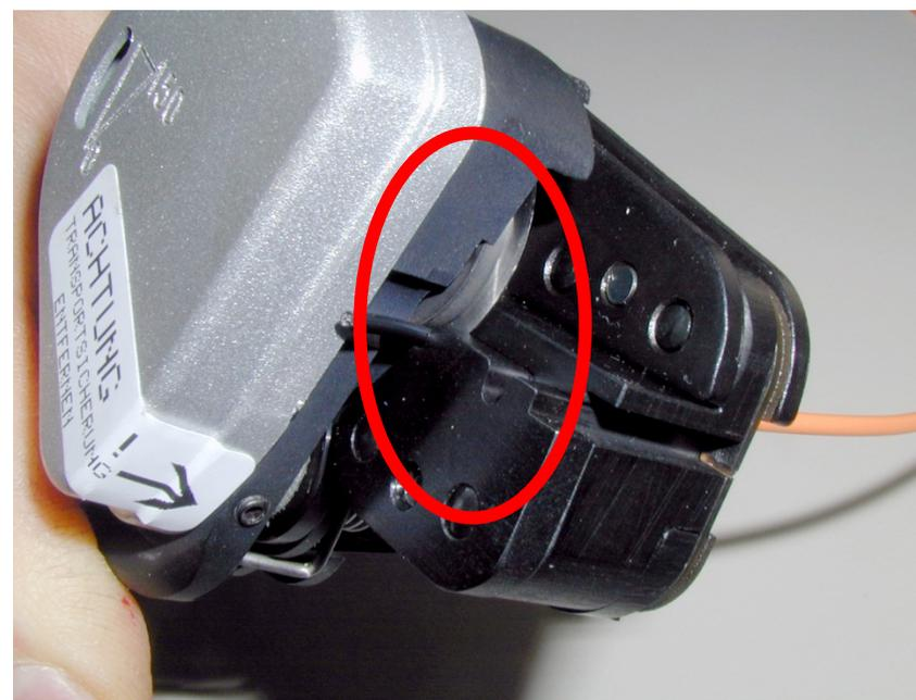
用切割轮切割光缆（精度切割）。为了避免折断光缆，切割不要太快！
